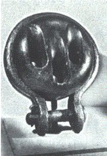
Een jufferblok: daar komt een stijve talie door, de talreep (Huite- ma) 37 . De palingschepen van W.A. Visser in Heeg hadden allemaal jufferblokken voor in de steven, daar ging de voorstag doorheen. Daar stond veel kracht op, daarom waren die juffer- blokken van pokhout (Van Brug) 38
