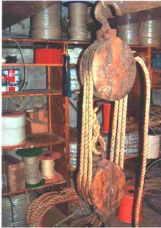
De takel van de laadboom op de kade leverde (4x3=) twaalfmaal krachtsvermindering (minus wrijvingsweerstand) 34
