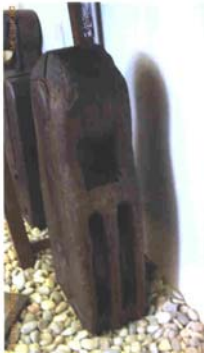
Een oud tweeschijfsstaartblok uit Lemmer 26 , mogelijk door Gurbe vervaardigd
